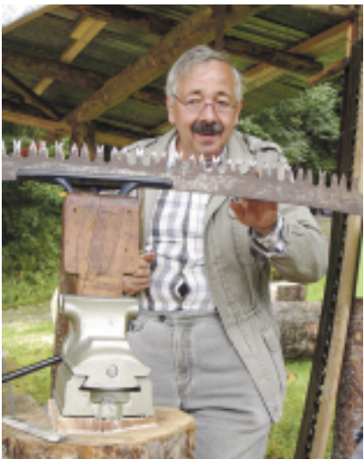
S. Wenger beim Hobelzahnsäge-Schleifen
